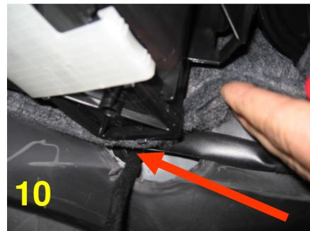
10) Rimontare il paraurti. Smontare la batteria e individuare nel vano motore lato passeggero sotto il supporto batteria il passacavo, inserire una sonda plastica per aiutare il passaggio del cavi dal vano motore all'abitacolo Rimuovere il cassetto portaoggetti.
