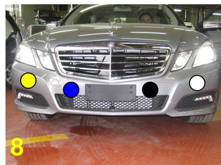
9) Fermare attraverso del nastro adesivo i cavi capsule al cblaggio originale posto sul paraurti.
