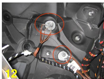
11) Installare l'altoparlante "buzzer" sul rivestimento plastico sotto al cassetto portaoggetti
